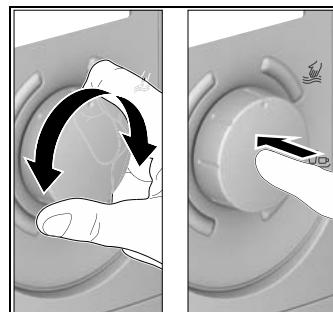
Door het draaien en indrukken van de draaiknop kan de watertemperatuur worden ingesteld en het menu bediend (zie hoofdstuk „Menu bedienen“).
