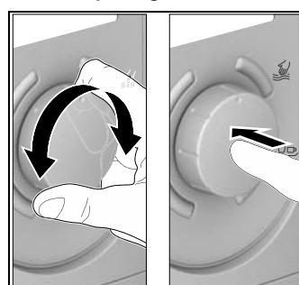
Ayar düğmesinin çevrilmesi ve basılmasıyla su sıcaklığı ayarlanabilir ve menü kullanılabilir (bakınız Bölüm “Menünün kullanılması”).
