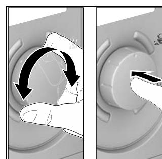
La température de l'eau peut être réglée et le menu peut être utilisé par rotation et actionnement du sélecteur rotatif (voir le chapitre « Utilisation du menu »).
