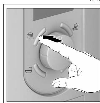
Le réglage de la température respectivement enregistré peut être sélectionné directement en appuyant brièvement sur les touches (douche, bain, rinçage) (voir le chapitre « Réglage de la température de l'eau »).
