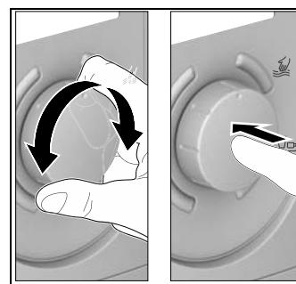
Durch Drehen und Drücken des Drehwählers kann die Wassertemperatur eingestellt und das Menü bedient werden (siehe Kapitel „Menü bedienen“).
